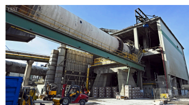
Dans le four rotatif de la cimenterie Vicat de Xeulley, la température atteint les 1 450 °C. Photo ER /C. JACQUOT
