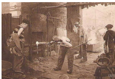
Le puddlage du fer, que Gustave Eiffel préférait à l'acier, consistait à affiner de la fonte en la brassant dans un four. Photo ER /Thierry FEDRIGO
